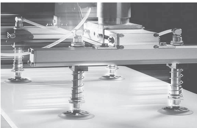
Вакуумный захват типа «паук» с пружинными плунжерами FSTF для манипулирования древесными плитами с покрытием
